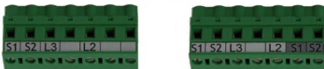
Rys. 4. Rysunek wtyków do regulatora z rozmieszczeniem i oznaczeniem zacisków aktywnych
